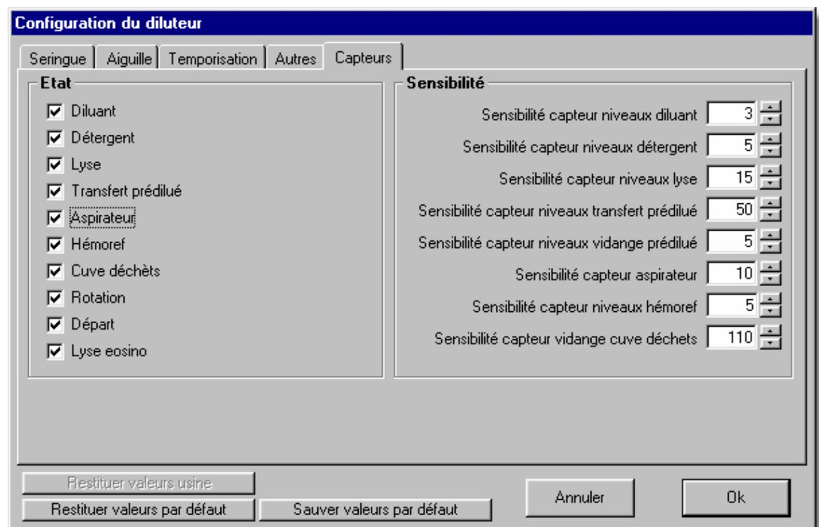
Le cadre 'Etat' permet d'activer ou de désactiver un capteur particulier. Si le nom du capteur est coché, il est activé.
